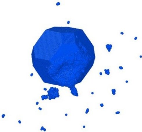
Figure 1 : Nanoparticule de Mo irradié par un PKA de 100 keV.
